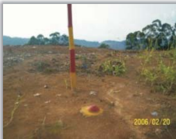
"Mojones para seguimiento topográfico"
